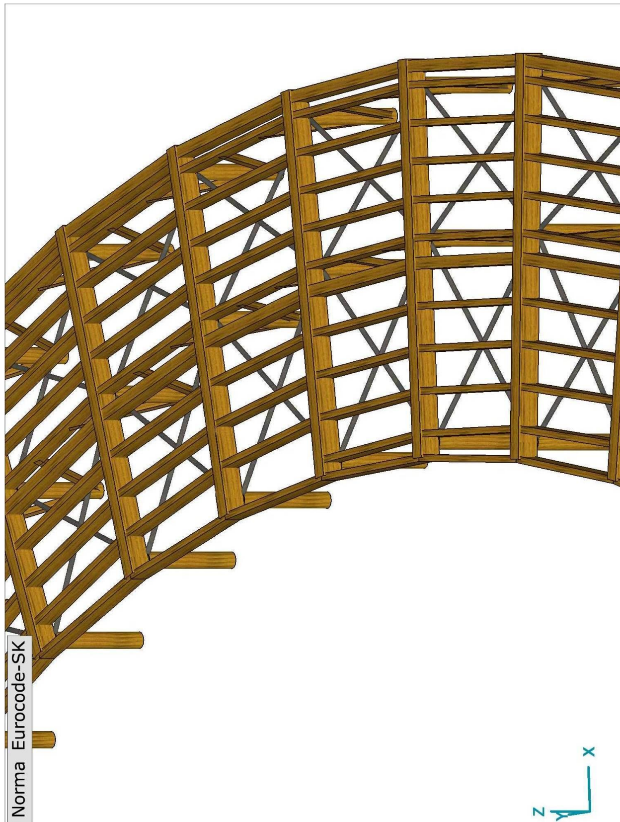
Obrázok 4.1-2 Pohľad na výsek nosnej konštrukcie lávky v najširšom mieste
